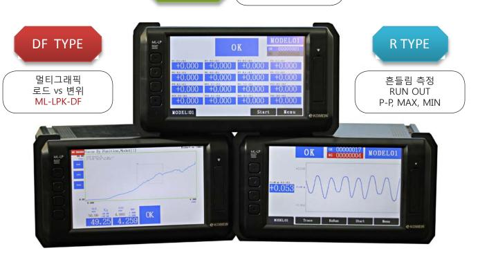
16 BIT AD CONVERTER 장착으로 0.1 m 초고정밀 측정에 용이 합니다. MICRO SD CARD 를 사용하여 측정데이터 소실을 해결 하였습니다. 3개국 언어지원 한글모드, 영어모드, 중국어모드로 편리성을 높였습니다.
